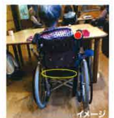
②座布団センサ(黄色部分)と ①位置検出タグ(●印)
